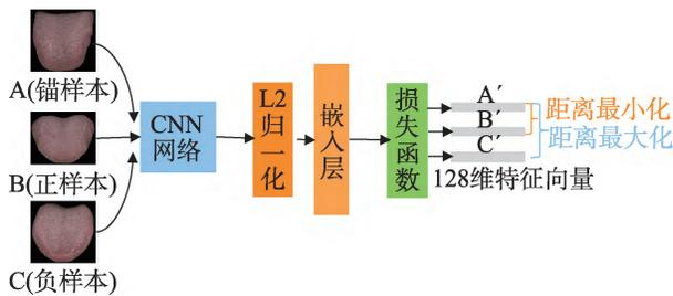
图4 算法整体框架
